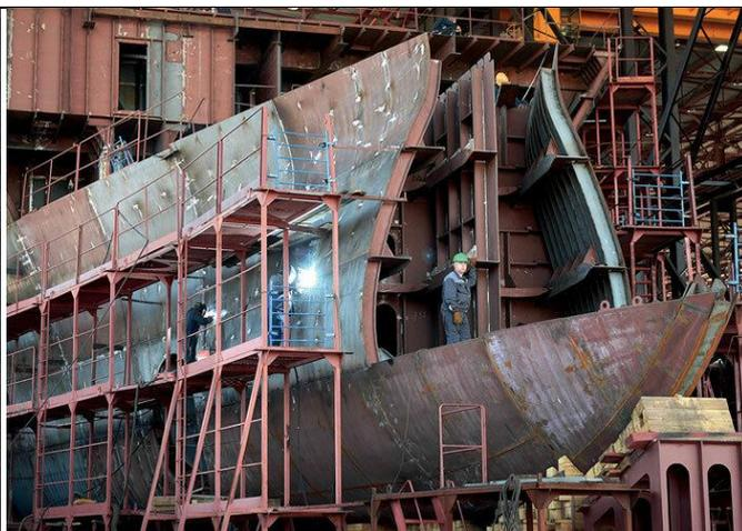
*Рис. 2. Каркас корабля из стали.*
