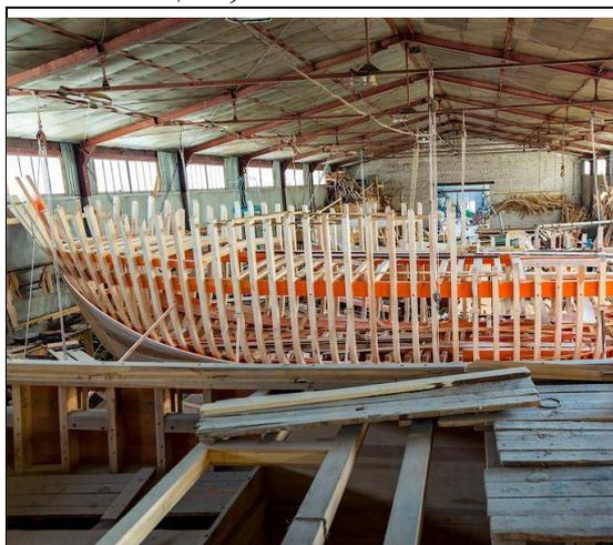
*Рис. 1. Каркас деревянного корабля.*
